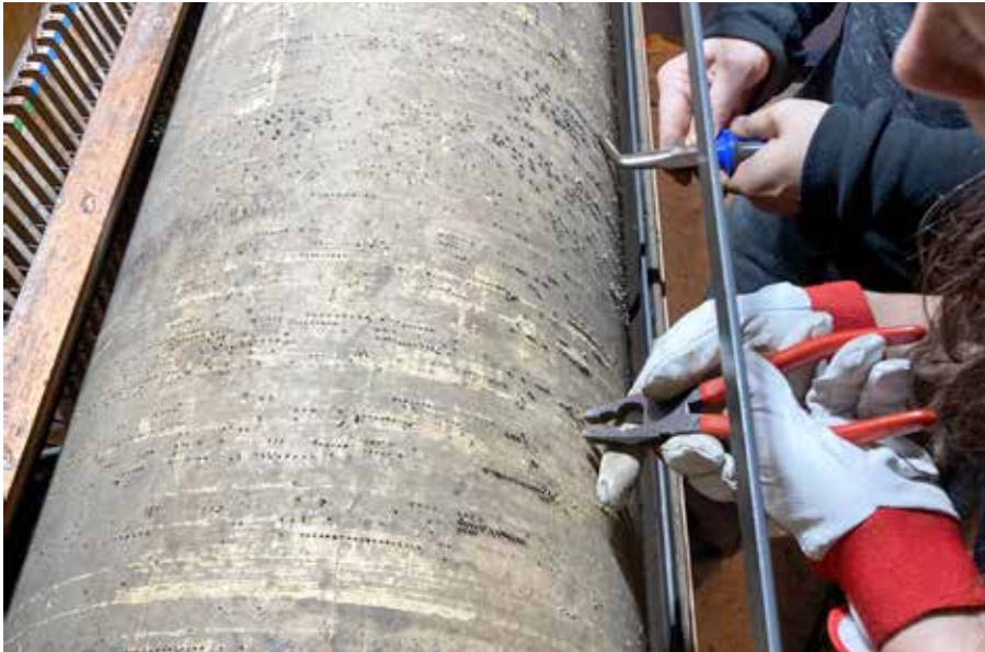
Stabilisierung und Restauration des Korpus , Entfernen von Saiten, Wirbel und Anschläge, Reinigung, Bau einer mobilen Unterkonstruktion, Abschleifen des Korpus, Entfernen aller Stifte auf der Walze
